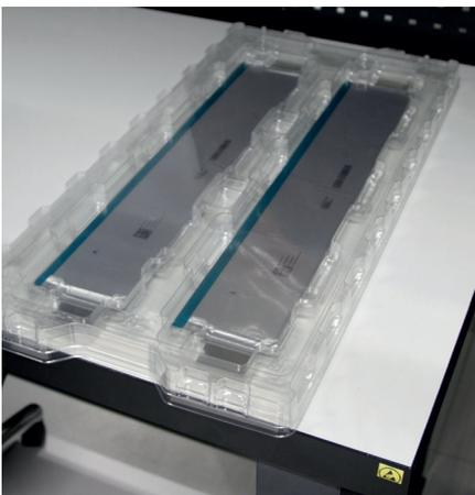
Für Busse und Nutzfahrzeuge kommen grosse Batteriezellen zum Einsatz. Diese werden zu Batteriemodule zusammengefügt.
