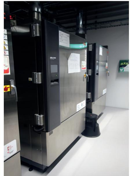
In diesen Klimakammern werden einzelne Zellen oder Module geprüft. Ein eigenes Batteriemanagementsystem kontrolliert dabei die Spannung und die Temperatur der Zellen.
