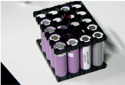
Im Labor untersuchen die Forscher alle Bauarten von Lithium-Ionen-Batterien. Die im Bild gezeigten Rundzellen werden für viele Consumer Electronic Geräte wie Laptops usw. eingesetzt. Der Vorteil dieser Bauart ist die günstige Produktion.
