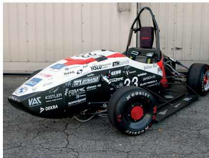
Das Formula-Student-Fahrzeug «mythen» von 2019 wurde komplett überarbeitet und alle aerodynamischen Flügel entfernt. Um genügend Anpresskraft zu erzielen, bauten die Studenten der ETH Zürich und der Hochschule Luzern des AMZ-Teams eine 1x2 m CFK-Platte unter Fahrzeug. Mittels Hochleistungsventilatoren wurde ein Anpressdruck von zusätzlich über 200 kg realisiert, um die Antriebskraft mit wenig Schlupf auf die Strasse zu bringen.
