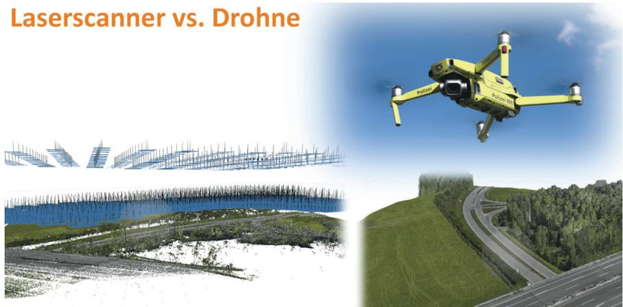
Die Flugbahn und Fotopunkte der Drohne werden vorgängig festgelegt (Bild links). Nach dem Flug werden die Bilder mittels Software zusammengefügt und der Unfallvorgang kann digital rekonstruiert werden. (Bilder: FOR und Unfalltechnischer Dienst der Stadtpolizei Zürich)
