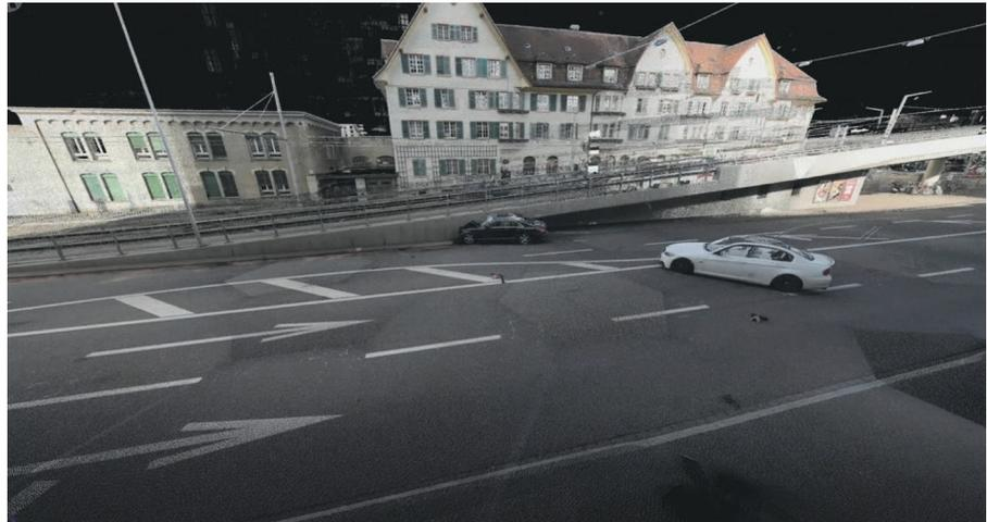
Mit einem Laser-Vermessungsgerät kann der Unfallort sowohl vermessen wie auch visualisiert werden. Damit können Geschwindigkeiten beim Unfallbergang analysiert und die Abfolge eruiert werden. Nebst Laservermessung wird die Photometrie oder Drohnen eingesetzt.
