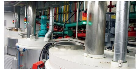
In zehn Mixern von einer bis 24 Tonnen Inhalt werden die Produkte gemischt.
