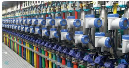
Aus den Vorratstanks werden die Flüssigkeiten präzise abgewogen in die Mischer geleitet.
