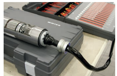
Dank viel Anschauungsmaterial und Schnittmodellen werden die Werkstattmitarbeiter der BMW-Händler über die Technik von BMW informiert. Im Bild der elektrische Wankstabilisator.
