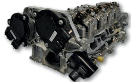
Beispiel Entwicklungsprojekte: Elektromotorische Ventilsteuerzeitenverstellung.
