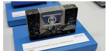
Massenmessung bei Durchfahrt: Dank Fahrbahnsensoren lässt sich die Maut berechnen.
