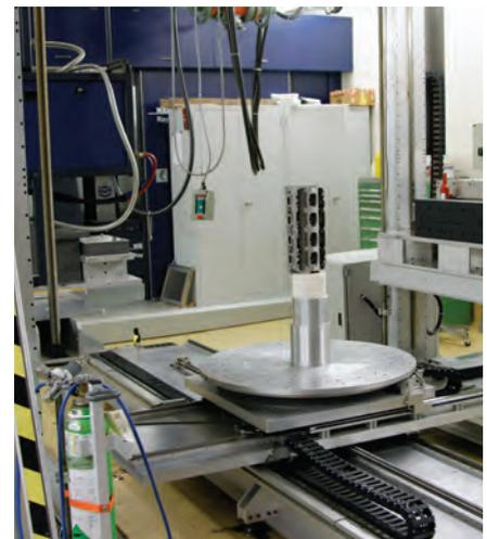
Im Röntgenhaus der EMPA können kleinste bis grosse Bauteile unterschiedlichster Materialien mittels Röntgentomographie zerstörungsfrei untersucht werden. Dabei lassen sich beispielsweise Schäden der Faserstruktur einer CFK-Gasflasche erkennen, ohne dass die Schäden von Auge sichtbar sind.
