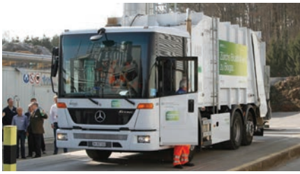
Die Anlieferung der Kompogasanlage der Axpo erfolgt von Privatpersonen wie auch von Entsorgungsunternehmen. Im Bild ein Sammelfahrzeug in Form eines Erdgaslastwagens.
