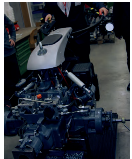
Die Topmodelle des Einachsers verfügen über einen Hydrostatantrieb, welcher die Lenkung über die Gabelbewegung zulässt.
