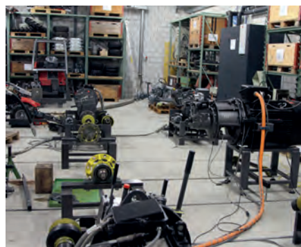
Im Motoren- und Getriebeprüflabor werden Neuentwicklungen getestet und Garantieprobleme behandelt.
