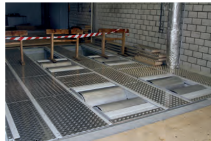
Auf dem neuen Allradrollenprüfstand können limitierte wie nicht limitierte Abgaskomponenten von Fahrzeugen mit unterschiedlichem Radstand und Antriebskonzepten (4x4, Hybrid mit Verbrennungsmotor vorne, E-Antrieb hinten) gemessen werden.
