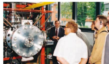
Am PSI können die verschiedensten Abläufe im Verbrennungsprozess experimentell dargestellt und verfolgt werden. Hier der Teststand für turbulente Vormischflammen.
