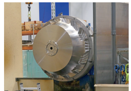
Alle Bauteile werden selber bearbeitet. Die Grenze liegt bei einer Masse von 30 Tonnen und einem Durchmesser von 2,5 m.
