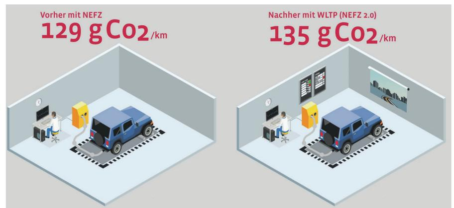
Ein Fahrzeug wird neu auf dem WLTP-Zyklus gemessen und muss auch bei den RDE (Real Drive Emission) auf der Strasse die Emissionsgrenzwerte einhalten. Gegenüber dem NEFZ wurde die Geschwindigkeit erhöht und damit stieg aufgrund des Zyklus der Verbrauch/CO<sub>2</sub>.
