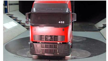
Im grossen Windkanal können Versuche bei Geschwindigkeiten bis 70 m/s durchgeführt werden.
