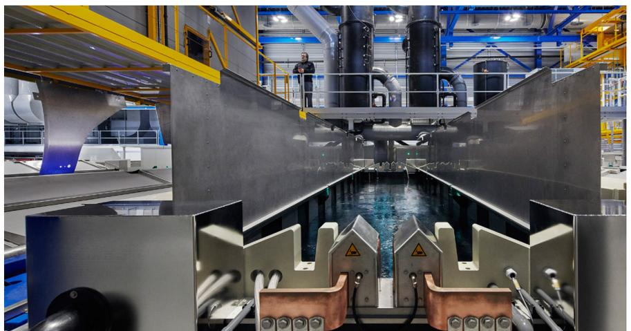
*In der vor zwei Jahren in Betrieb genommenen Oberflächenbehandlungsanlage können Bauteile bis zu einer Länge von sieben Metern galvanisiert, lackiert und auf Risse überprüft werden.*
