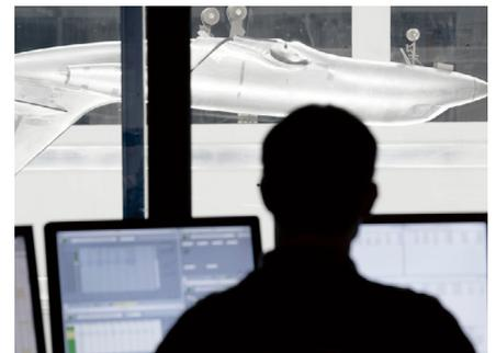
Flugzeugmodelle werden in Flug- oder Rückenlage mit einer Sechskomponentenwaage gemessen.
