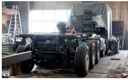
Der vorgefertigte Rahmen des Aufbaus wird auf dem Chassis des Lastwagens befestigt.
