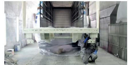
In zwei Lackierkabinen werden die Fahrzeugaufbauten grundiert und lackiert.
