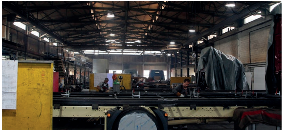
In der ältesten Werkhalle entstehen pro Jahr 350-400 Objekte: 70 bis 100 davon sind gezogene Fahrzeuge (Anhänger, Auflieger) und die anderen sind Aufbauten für neue Lastwagen.
