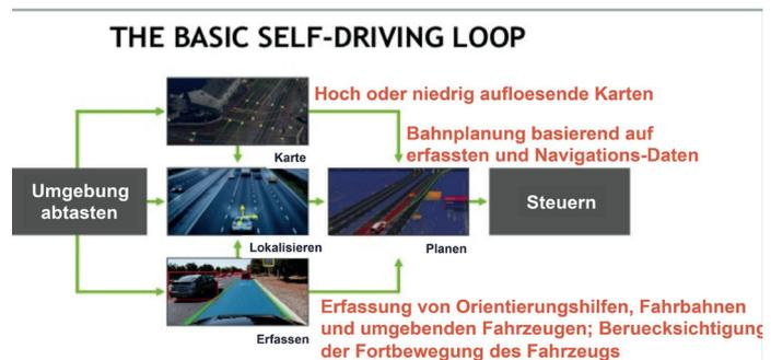
Verschiedene Technologien müssen für das autonome Fahren zusammengeführt werden. Hochaufgelöste Strassenkarten und eine Positionsgenauigkeit von plus/minus 10 cm sind unabdingbar für autonomes Fahren.
