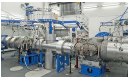
Der im Jahre 2013 neu errichtete Prüfstand „JUNGFRAU“ unterstützt die Entwicklung 2-stufiger Aufladesysteme der 2. Generation mit einem Druck von 12 bar und einem Aufladewirkungsgrad von 75%.
