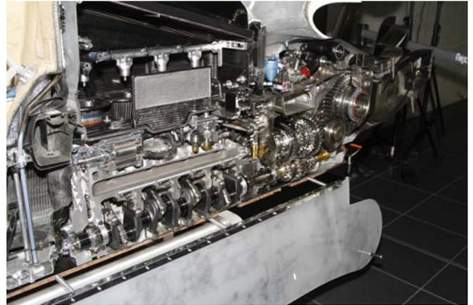
Schnittmodell F1 Motor und Getriebe
