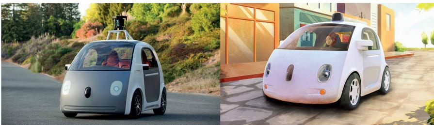
Links der Prototyp und rechts die CAD-Variante des Google-Car. Der Ingenieursprämissen folgend «form follows function» ist die Form für die optimale Sensorausnutzung der drehbaren Laserkamera auf dem Dach und dem Frontbereichsradar gewöhnungsbedürftig. Der Prototyp sorgte Ende Mai 2014 in allen Medien für Aufsehen. Details werden noch geheim gehalten.
