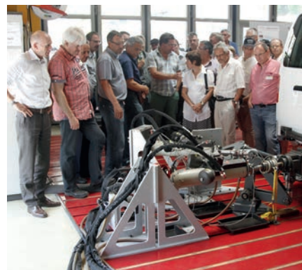
Beim Rundgang konnten die Gäste sich von den Dienstleistungen der DTC AG ein Bild machen. Unter anderem wurde die Festigkeitsanalyse einer Anhängerkupplung gezeigt, die im Dauerversuch erprobt wird.
