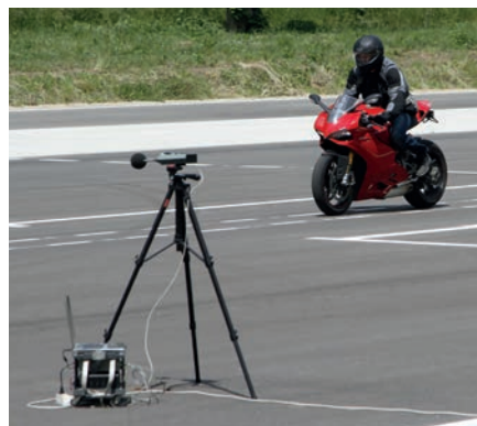
Auf dem speziellen Geräuschmessbelag können normgerechte Lärmessungen angeboten werden. Die Vorbeifahrtsmessungen sind somit reproduzierbar und die Anfahrtswege für Kunden kurz und effizient.
