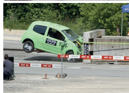
2 Mal Renault Twingo mit 50 km/h in ein Hindernis: 20 Jahre Fortschritt in der passiven Sicherheit eindrücklich demonstriert.
