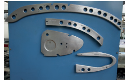
Eine der Spezialitäten ist die Blechbearbeitung: Dabei werden Aluminiumbleche gefräst und gebohrt, gereinigt, wärmebehandelt, plangerichtet und geformt/gepresst.
