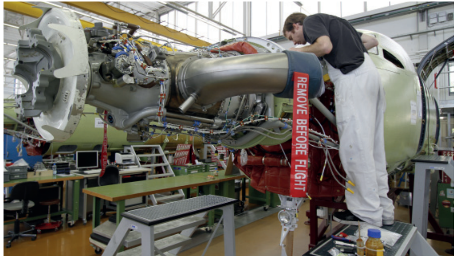
Viel Handarbeit steckt in der Produktion der Pilatus Flugzeuge. Jeder Arbeitsschritt ist detailliert in Montageanweisungen beschrieben und Konstruktionspläne helfen dem Fachpersonal, die 10 km elektrischen Kabel, diverse hydraulischen Leitungen und unzählige Bauteile zusammenzufügen. Rund 45'000 Arbeitsstunden sind notwendig, um ein Flugzeug zu fertigen.
