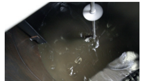
Das Basisöl und die Zutaten wie Additive werden mehrere Stunden im Misch tank gerührt, bevor sie in Gebinde abgefüllt werden.
