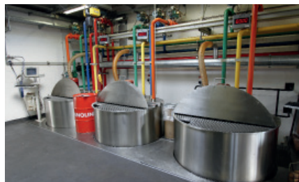
Die drei Blending-Mischer fassen 5000 kg Basisöl und Additive. Die Öle werden nach Rezeptur mit bis zu 20 Additiven gemischt.
