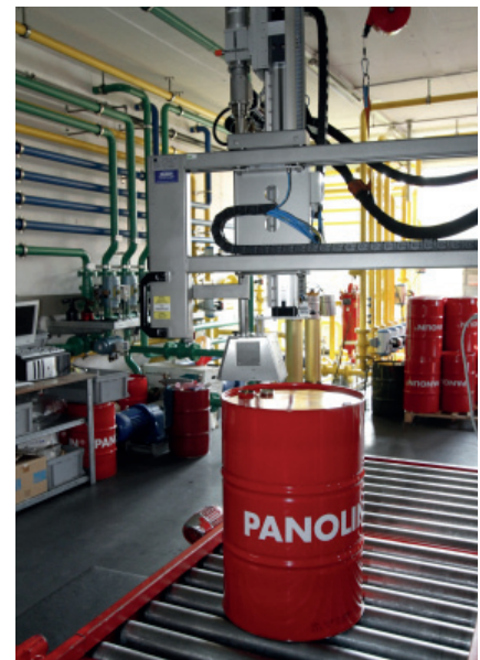
In der Fassabfüllanlage können pro Tag 200 Ölfässer grammgenau abgefüllt werden. Es werden ausschliesslich Fachhändler und Garagisten mit den Produkten beliefert.
